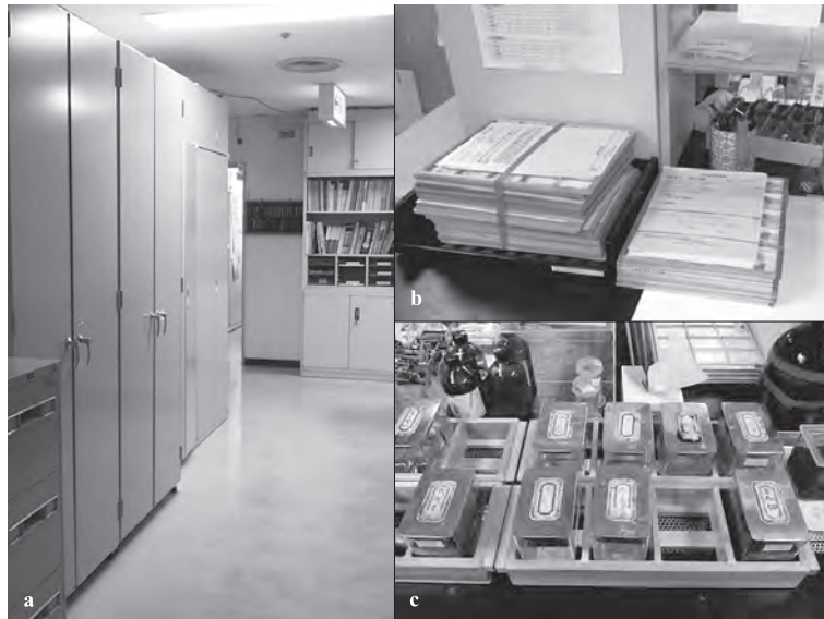
図4 震災後の対応、ブロックや標本の保管棚には必ず施錠する (a)、マップはゴムで縛る (b)、染色液の入ったバットはケースに入れる (c) などの工夫をし、落下や破損を防止している。
